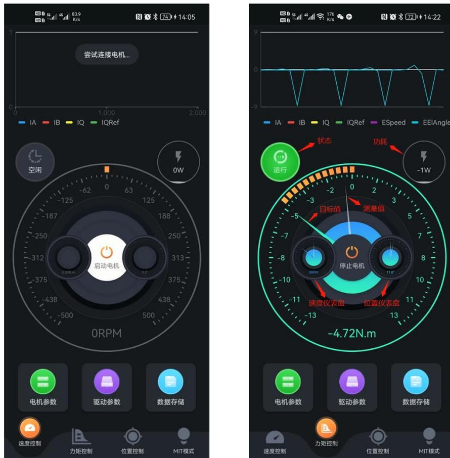
图 3 电机启动与停止示意图
