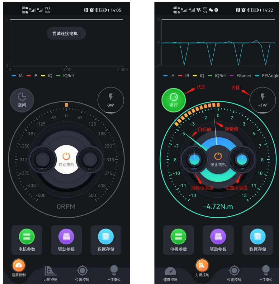
图 3 电机启动与停止示意图
